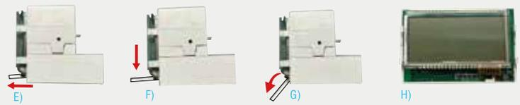
3. Montare la linguetta di estrazione e il frontalino di colore differente, seguendo la procedura inversa a quella di smontaggio.
